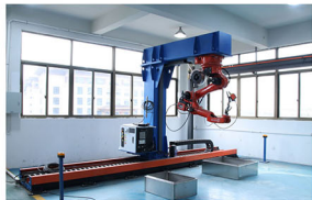
桁架单轨道气保焊工作站
